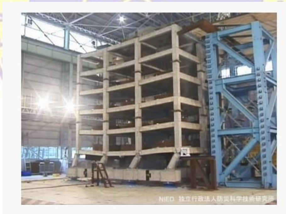
Gambar 4. 18 : Proses uji coba bangunan menggunakan Shaking Table
