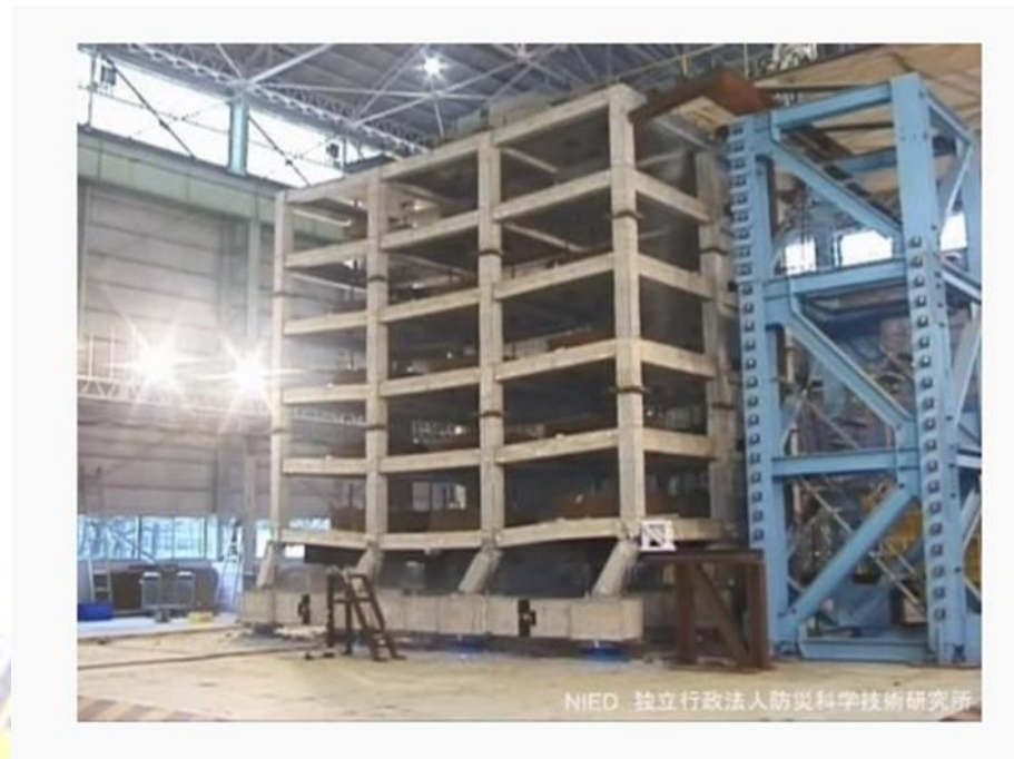
Gambar 4. 3 : Video proses uji coba bangunan dengan Shaking Table
